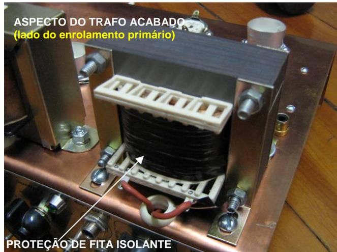
17) Encaixe a bobina na pilha de Lâminas “E”, conforme ilustrado abaixo, parafusando a base das cantoneiras para que fique bem firme.
